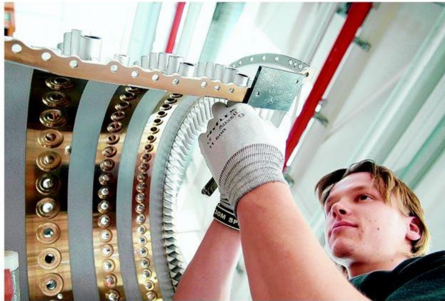
Im Oberurseler Rolls-Royce-Werk montiert der Mechaniker Lothar Kümmel einzelne Schaufeln am Gehäuse eines Rotors.
